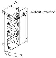
**ROLLOUT PROTECTION ON BURNER BRACKET**
